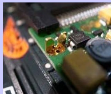
基板側には、クリップが外れた穴が残る
