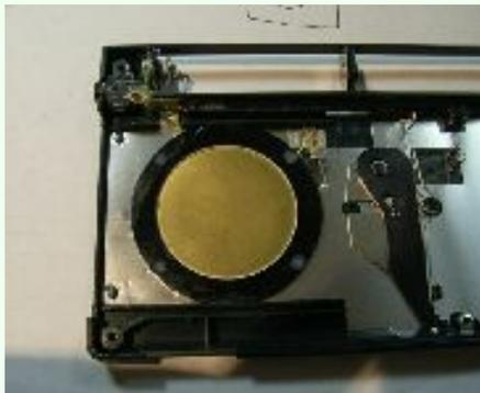
なおジャックの取り付けは、上下の筐体ではさんでいるだけであり、接着剤は使用していません。（分解、改造容易性、電池蓋挿入への阻害要因考慮です。）
